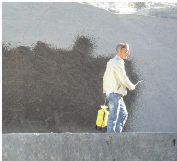
Links: Abbau mit Seilsäge im Bruch »Bohus Rot« Rechts: Wasser macht die Strukturen des Hallandia-Gneises sichtbar.
